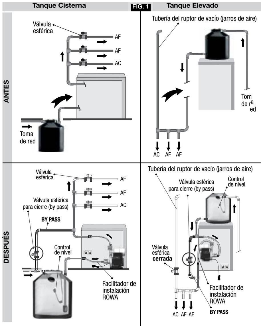
**A.2)** La tubería de alimentación del presurizador proveniente del tanque cisterna o elevado deberá cumplir con un diámetro igual o mayor medida nominal para los equipos .
